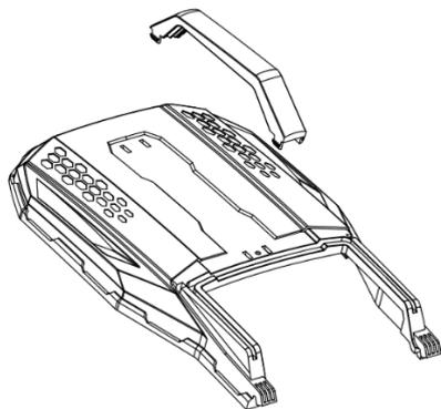
Зафиксируйте пластиковую ручку для переноски на верхней крышке травосборника как показано на иллюстрации.
