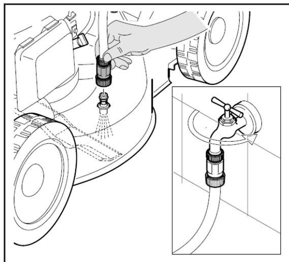
**ВНИМАНИЕ!** Запрещается поднимать косилку над поверхностью земли или включать привод колес во время производства мокрой очистки корпуса. Брызги воды могут попасть в двигатель или лезвия могут повредить шланг.
