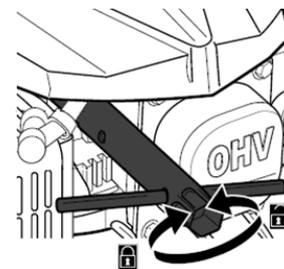
затяните ее ключом. Недостаточная затяжка свечи зажигания может привести к ее перегреву и повреждению двигателя.
