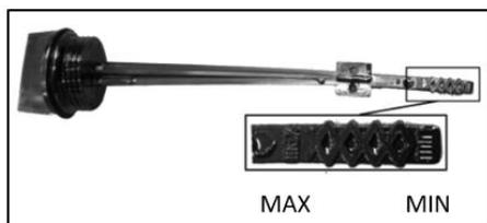
**Важно!** Перед опусканием щупа в маслозаливную горловину для контроля уровня, подождите 1 минуту, чтобы масло стекло со стенок горловины, а также протрите насухо щуп во избежание неверных трактовок уровня масла.
