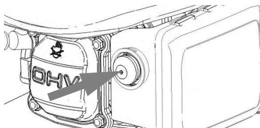
Нажмите на праймер подкачки топлива 1-4 раза в зависимости от температуры окружающей среды.
