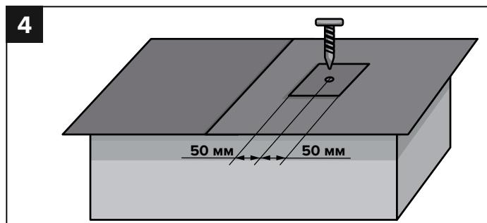
При возникновении зон механического крепления через материал, зону крепления необходимо усилить дополнительным слоем материала шириной не менее 50 мм по обе стороны от крепления. Усиление укладывается на тонкий слой битумной мастики.
