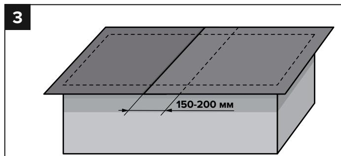
На место поперечного перехода наносится тонкий слой битумной мастики. Ширина поперечного перехода составляет 150–200 мм.
