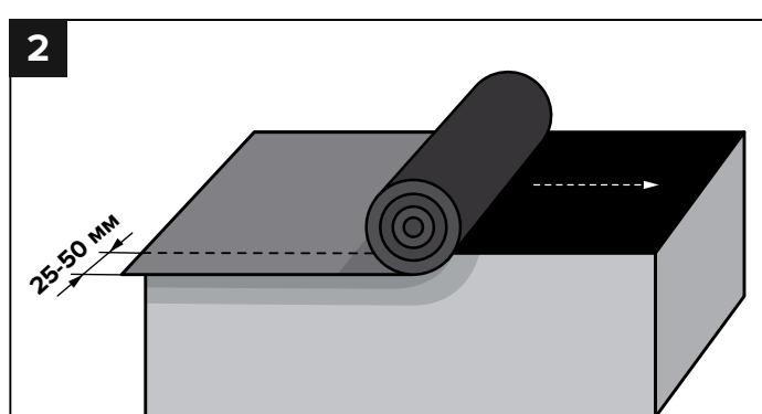
На основание, обработанное мастью, уложить материал так, чтобы он выступал за габариты будущих стен на ширину не менее 25–50 мм.
