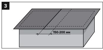
На место поперечного перехлеста наносится тонкий слой битумной мастики. Ширина поперечного перехлеста составляет 150–200 мм.
