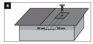
При возникновении зон механического крепления через материал, зону крепления необходимо усилить дополнительным слоем материала шириной не менее 50 мм по обе стороны от крепления. Усиление укладывается на тонкий слой битумной мастики.
