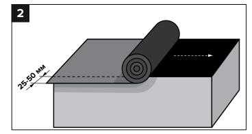
На основание, обработанное мастикой уложить материал так, чтобы он выступал за габариты будущих стен на ширину не менее 25–50 мм.
