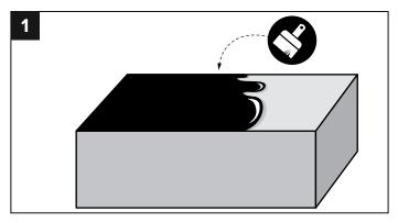
Очистить основание от грязи и пыли. Нанести сплошным слоем битумную мастику. Толщина нанесения мастики не более 1 мм.
