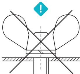
⚠ Не допускать смыкания пружинной шайбы
