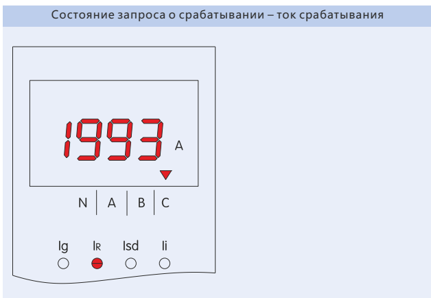
Состояние запроса о срабатывании – ток срабатывания
