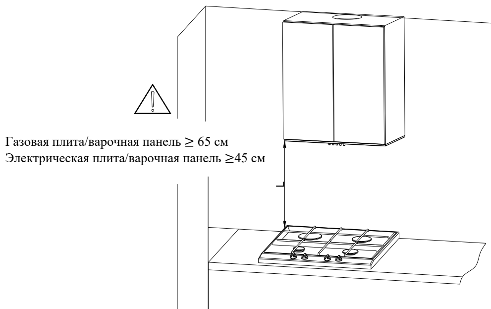
Рис. 3 Рекомендуемое расстояние для установки
