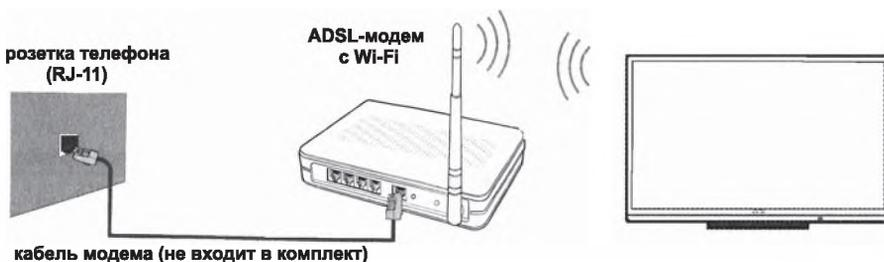
Рисунок 7 – Беспроводное подключение
