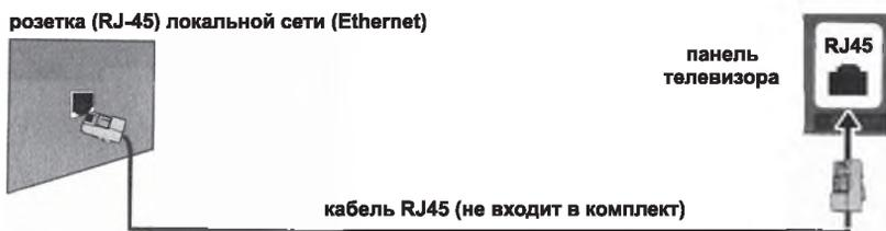
Рисунок 6 – Проводное подключение
