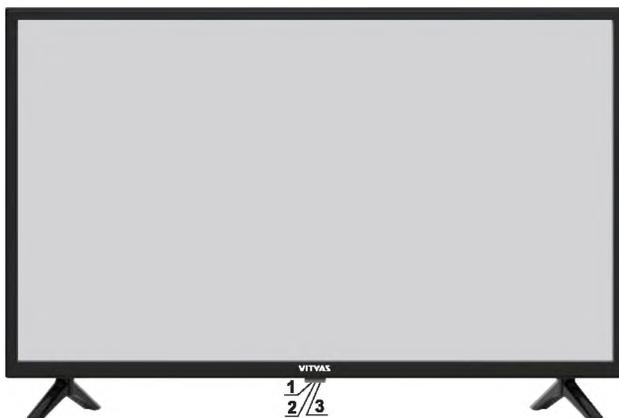
1 – окно фотоприемника; 2 – индикатор режима работы телевизора; 3 – кнопка-джойстик.
