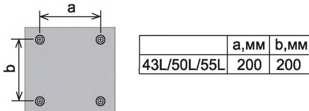
Рисунок 4 – Размеры для выбора настенного кронштейна
