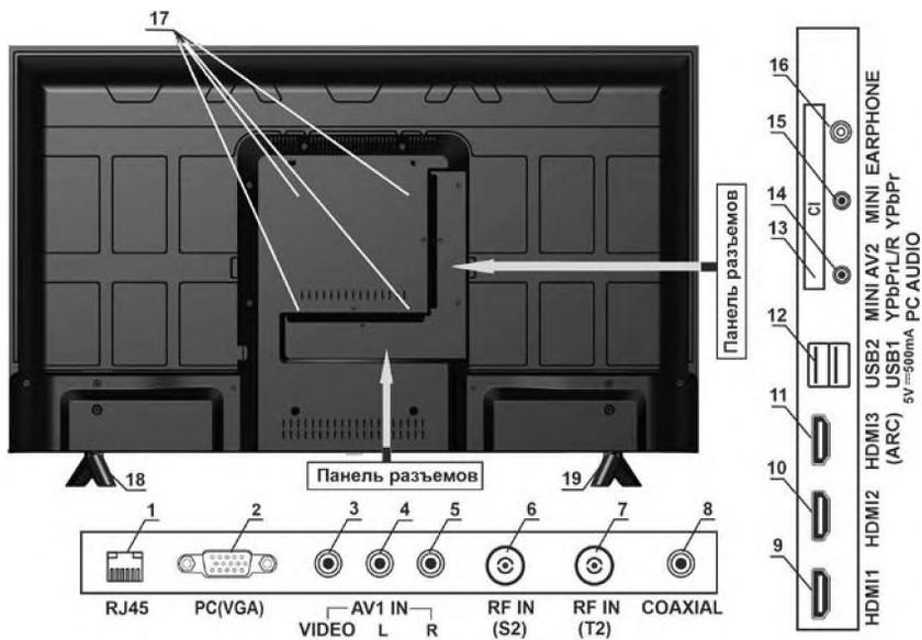
1 – вход **RJ45** для подключения к сети Интернет; 2 – вход **PC(VGA)** для подключения видеосигнала с компьютера; 3 – вход видео **VIDEO** композитного разъема **AV1 IN**; 4 – вход звука **L** композит-
