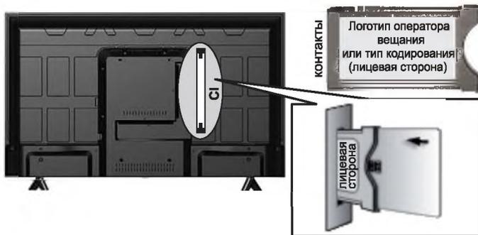
Рисунок 5 – Установка СА-модуля
