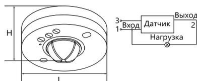
Инфракрасный потолочный с регулировкой освещенности, времени задержки от 10 секунд до 7 минут и расстояния обнаружения
