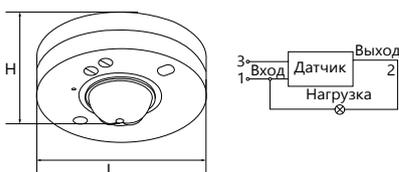
Инфракрасный потолочный с регулировкой освещенности и времени задержки от 10 секунд до 7 минут.
