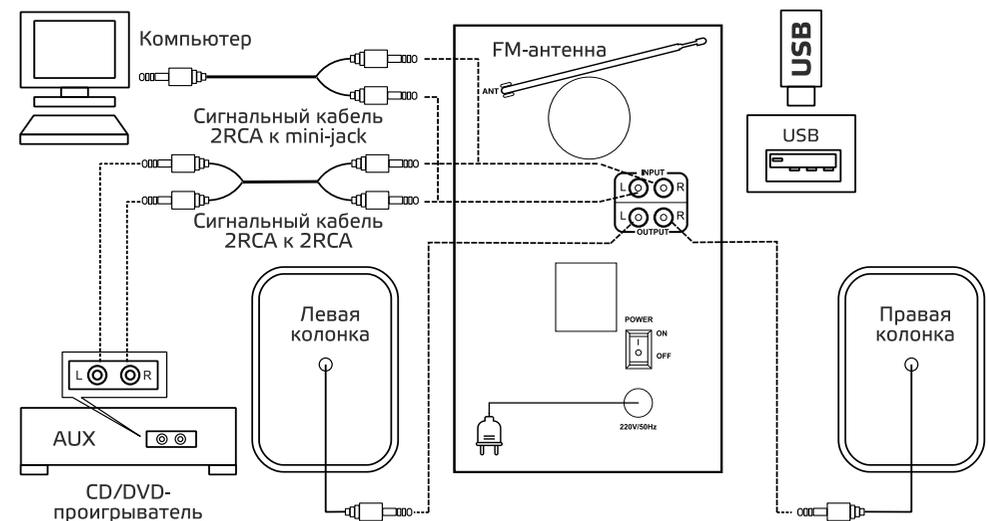
Обратите внимание, что АС может быть подключена только к линейному выходу источника сигнала, запрещается подключать систему к выходу усилителя, так как это может привести к выходу АС из строя. Перед подключением убедитесь, что АС отключена от сети.
