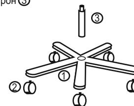
6. Сиденье установите отверстием в механизме ④ на газпластон ③.
