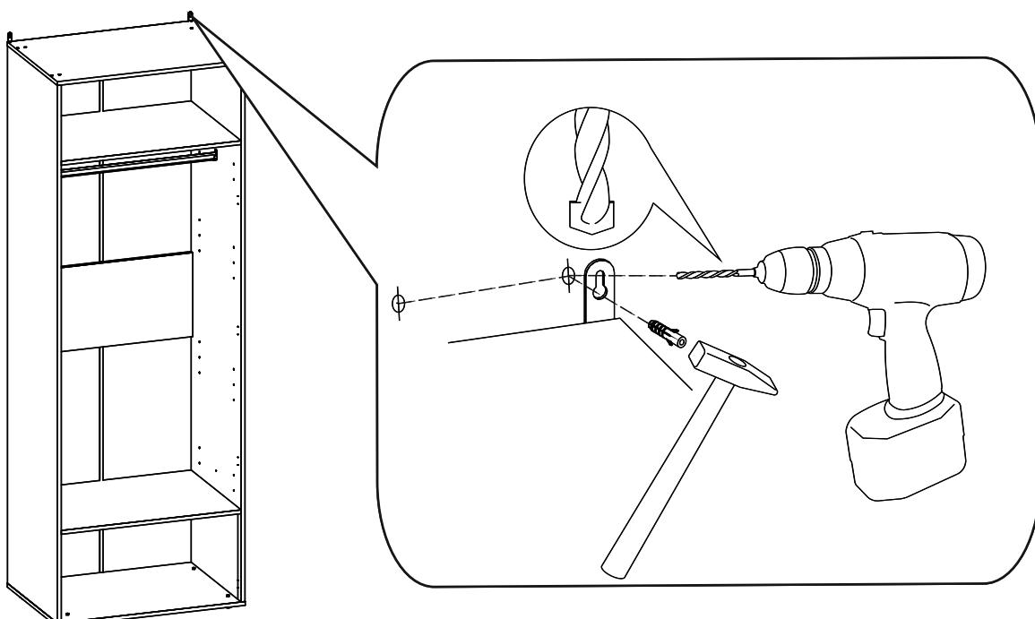
**Для избежания повреждения газовых, вентиляционных, водопроводных отверстий и электрических коммуникаций, обратите внимание на их расположение!**
