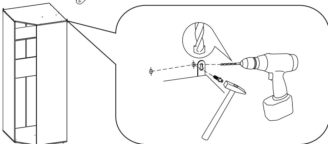
**Для избежания повреждения газовых, вентиляционных водопроводных отверстий электрических коммуникаций, обратите внимание на их расположение!**
