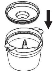
4. Сверху установите моторный блок, при этом ось блока ножей или венчика должна попасть в паз моторного блока. Убедитесь, что моторный блок плотно прилегает к чаше. Нажмите на кнопки блокировки по бокам, чтобы зафиксировать моторный блок на чаше.
