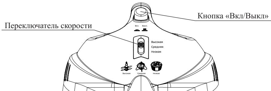
Прибор включается и выключается кнопкой «Вкл/Выкл». Переключателем скорости выбирается нужная скорость, их 3 — низкая, средняя и высокая.
