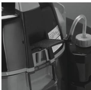
Налейте примерно 2.5л чистой воды в прозрачный бачок (1) так, чтобы параллельно основанию патрубков L-образной трубки (40) был покрыт водой
