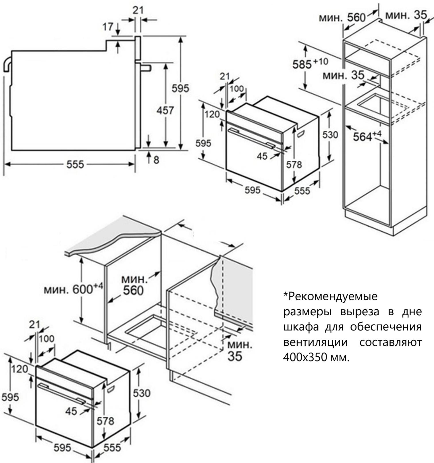
\*Рекомендуемые размеры выреза в дне шкафа для обеспечения вентиляции составляют 400x350 мм.
