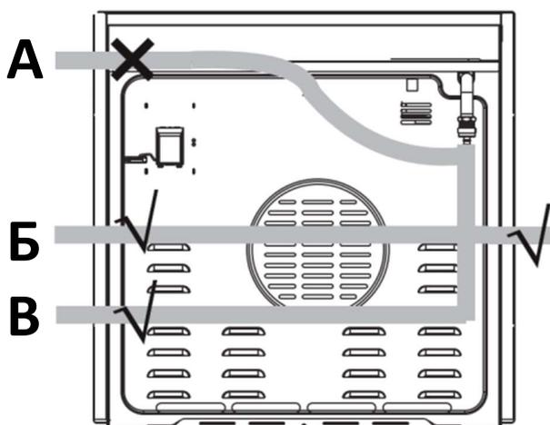
Если для подключения используется гибкий шланг, то его нельзя устанавливать в положение «А».
