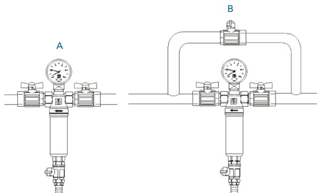
6.4 Муфтовые соединения должны выполнять с использованием в качестве уплотнительных материалов ФУМ (фторопластовый уплотнительный материал).
