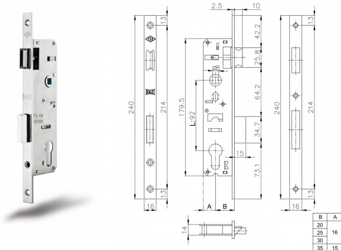
Врезной узкопрофильный замок **Kale Kilit 192P** предназначен для установки на ПВХ двери, а так же другие узкопрофильные. Корпус замка выполнен из стали с гальваническим покрытием, ригель и защелка из цинкового сплава ZAMAK с хромированным покрытием.
