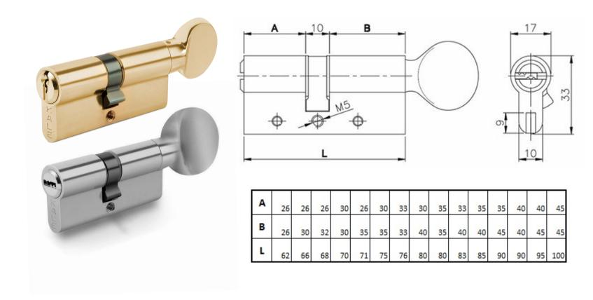
Цилиндровый механизм с вертушкой серии **Kale 164 BM** имеет 2-ой класс безопасности, 5 миллионов комбинаций. Количество комбинативных пинов - 10. Цилиндр оборудован стальным штифтом против высверливания. Для усложнения вскрытия цилиндров отмычкой используются пины грибовидной формы. Тип ключа: перфорированный. Исполнение: ключвертушка. Комплектация: 5 латунных ключей, крепежная фурнитура, гарантийная карта. Цвет: никель/латунь.
