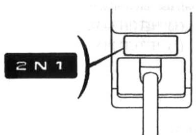
**Примечание:** Если рычаг переключения передач не перемещается в желаемое положение, выжмите рычаг сцепления и слегка переместите мотокультиватор, чтобы вернуть передачи в исходное положение.
