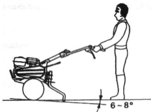
Для того чтобы получить наибольшую работоспособность мотокультиватора, необходимо управлять им, как указано на рисунке.
