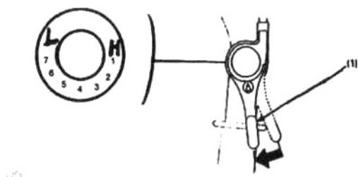
5. Плавно потяните за пусковую рукоятку до начала сопротивления, а затем резко потяните.
