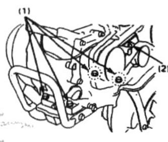
Отпустите крепежные болты на стопорном механизме ремня. Отрегулируйте зазор между стопорным механизмом ремня и самим ремнем, как указано на рисунке (при этом действии сцепление должно быть выжатым).
