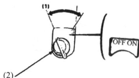
3. Поверните топливный краник в положение "выключено" (OFF).
