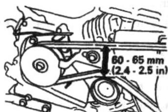
Для того чтобы произвести регулировку необходимо отпустить четыре установочных болта. Переместите двигатель вперед или назад, чтобы отрегулировать соответствующую натяжку.
