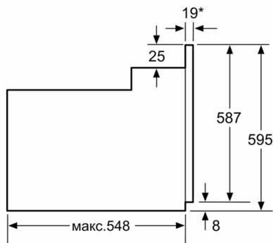
\* При металлической фронтальной панели 20 мм
