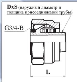
Соединители конусные являются импортзамещающей продукцией. Изделия предназначены для присоединения полимерных труб к трубопроводной арматуре в системах отопления и водоснабжения при температуре рабочей среды до 120°C и номинальном давлении до 1,0 МПа.
