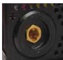
**Универсальный разъем DX 35/50 для подключения сварочных кабелей**
