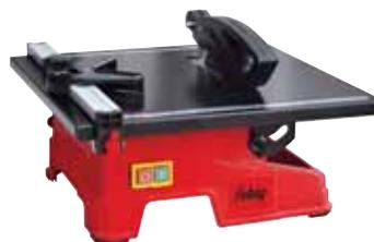
Электрический станок FUBAG FM 180 PLUS незаменим для аккуратной и быстрой резки прочной керамической плитки, камня и других материалов. За счет нижнего расположения двигателя и охлаждения диска при помощи поддона с водой распил ведется без пыли.
