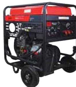
Профессиональный сварочный генератор разработан для проведения сварочных работ с использованием электродов с различным типом покрытий: рутиловым, основным и целлюлозным. Работает на базе мощного бензинового двухцилиндрового OHV-двигателя. Топливный бак объемом 45 литров позволяет агрегату непрерывно выполнять свои функции до 10 часов без дозаправки.
