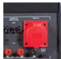
**Розетка 400 В / 16 А. Клеммы для однофазных и трехфазных потребителей**
