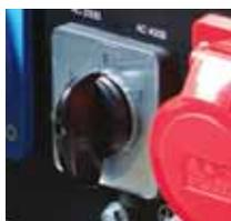
**Работа в однофазном и трехфазном режимах**
