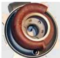
**Рабочее колесо и улиты насоса из высокотехнологичных материалов**
