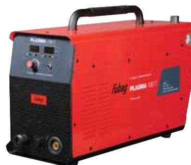
Мощный инверторный аппарат для воздушно-плазменной резки с бесконтактным поджигом и с высокой производительностью. Обеспечивает максимальную толщину реза углеродистой стали до 35 мм.
