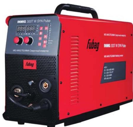
**Универсальный трехфазный полуавтомат с максимальным током 300 Ампер для MIG-MAG, MMA и TIG LIFT DC сварки. Работает в импульсном режиме. Имеет синергетическое управление в режиме MIG-MAG.**
