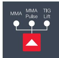
Сварка в режимах MMA / TIG Lift / MMA Pulse
