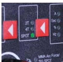
**SPOT – режим точечной сварки для выполнения прихваток**
