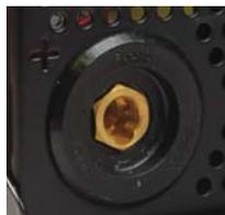
Универсальный разъем для подключения сварочных кабелей
