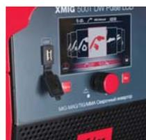
**Разъемы USB для обновлений программного обеспечения на источнике и на выносном механизме**
