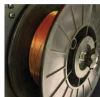
**Механизм подачи адаптирован под катушки 1 и 5 кг**
