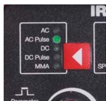
**Сварка в импульсном режиме**
