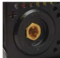
Универсальный разъем для подключения сварочных кабелей
