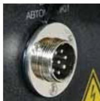
**Разъем для подключения блока автоматики**
