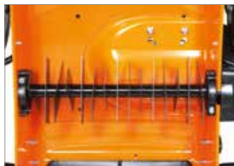
Ротор, состоящий из 15 стационарных ножей.
