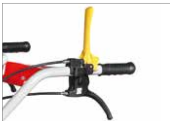
Рычаг на руле для переключения передач.
