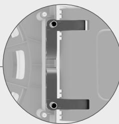
**Metalowe elementy wzmacniają połączenie zwijacza z wieszakiem i zapewniają jego bezpieczne użytkowanie**
