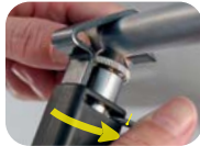
Разрезание оплетки методом вращения
