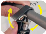
Разрезание оплетки методом вращения
