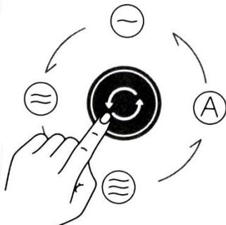
Для настройки яркости дисплея служит кнопка регулировки яркости дисплея, позволяющая включить высокую яркость, низкую яркость или выключить подсветку.
