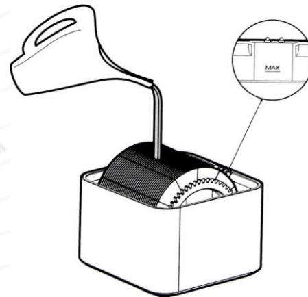
Перед установкой верхнего кожуха воду можно залить непосредственно в резервуар до максимальной отметки (Выступ с отметкой "MAX").
