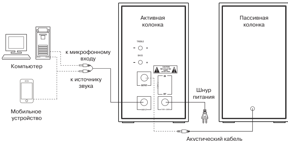
Рис. 2. Схема подключения
