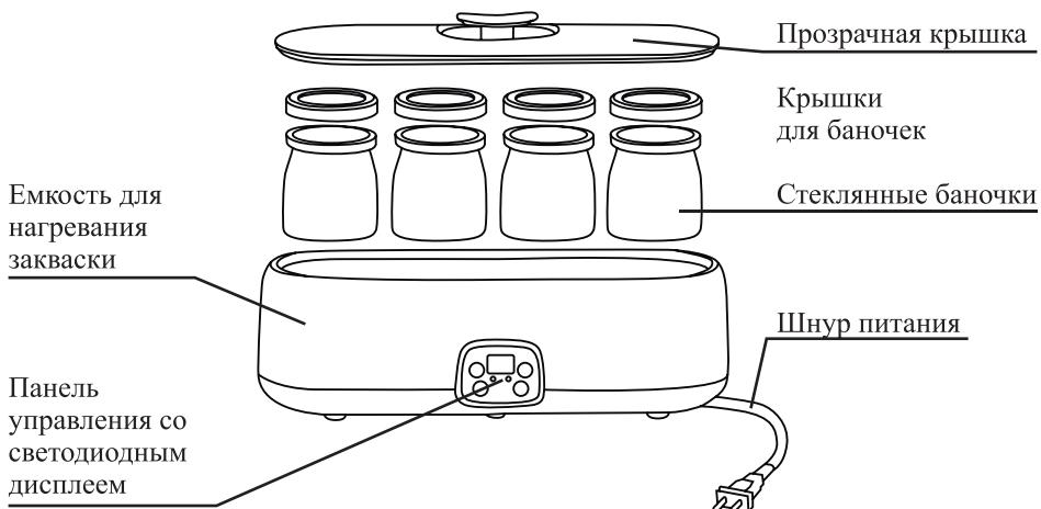
Йогуртница равномерно нагревает баночки с приготовленной смесью до заданной температуры и поддерживает ее в течение установленного времени.
