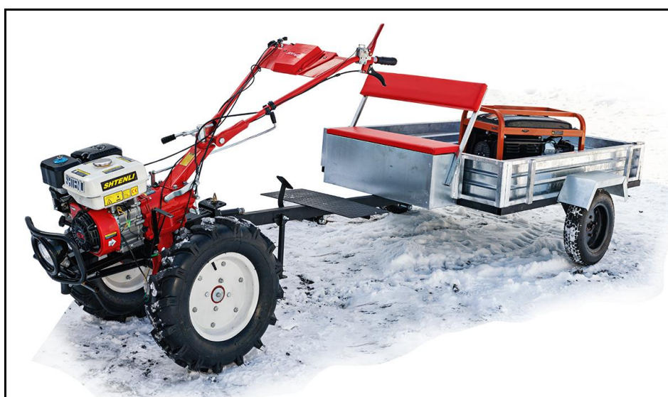
19. При выгрузке с тележки сыпучего груза необходимо открыть или снять задний борт (путем открытия фиксаторов борта), вынуть блокирующий болт из кронштейна (поз.10 Рис.1) и опрокинуть кузов вручную против часовой стрелки.
