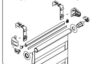
СБОРКА И МОНТАЖ ШТОРЫ! ВСТАВЬТЕ МЕХАНИЗМ (5) И ОПОРНУЮ ВТУЛКУ (6) В ТРУБУ ШТОРЫ (1) ПРЕДВАРИТЕЛЬНО ОДЕВ НА КАЖДУЮ ИЗ НИХ ПОДКЛАДОЧНЫЕ КОЛЬЦА (7). ДЛЯ ОТКРЫВАЮЩЕЙСЯ СТВОРКИ ОКНА НЕОБХОДИМО СОЕДИНИТЬ СКОБУ (2) С КРОНШТЕЙНОМ (4), НАКЛЕИТЬ ДВУХСТОРОННИЙ СКОТЧ (В КОМПЛЕКТЕ) НА СКОБУ (2), ПРИСОЕДИНИТЬ ПРОФИЛЬ (3). В ИНЫХ СЛУЧАЯХ МОНТАЖА ИСПОЛЬЗОВАТЬ ПЛОЩАДКУ (11).
