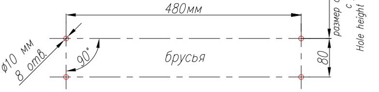
Строго придерживайтесь данных размеров, выдерживайте горизонталь. Отверстия в стене засверливайте аккуратно на нужную глубину, не допускайте разбития отверстий при сверлении и увода сверла в сторону от намеченной точки.
