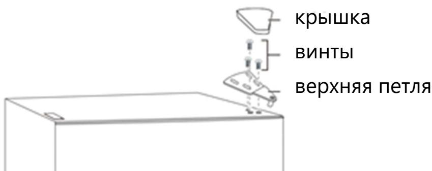
2. Снимите дверь морозильной камеры.
