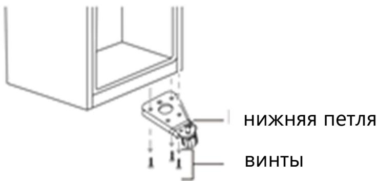
4. Снимите шайбу и гайку, которые крепят вал штифта к правому отверстию на нижней петле, и затем снимите вал.
