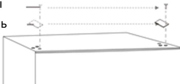
11. Закрепите верхнюю петлю в верхней левой части шкафа тремя винтами, которые вы удалили ранее. Перед тем, как затягивать винты верхней петли, убедитесь, что верхняя часть двери находится на одном уровне с корпусом, а резиновая прокладка обеспечивает хорошее уплотнение.
