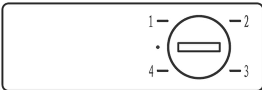
Отрегулировать температуру в морозильной камере можно, повернув регулятор установленный на верхней части прибора.
