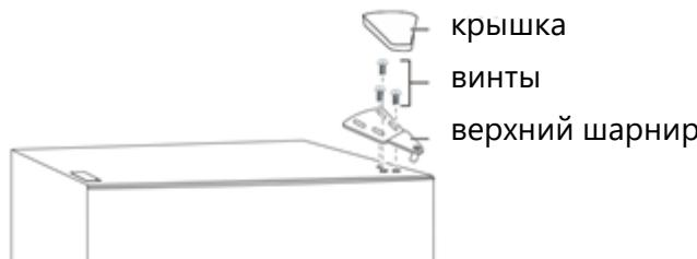
2. Снимите дверь морозильной камеры.
