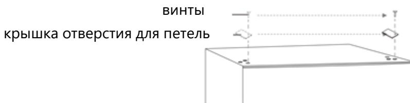
18. Закрепите верхний шарнир в верхней левой части шкафа тремя винтами, которые вы удалили ранее. Перед тем, как затягивать винты верхнего шарнира, убедитесь, что верхняя часть двери находится на одном уровне с корпусом, а резиновая прокладка обеспечивает хорошее уплотнение.
