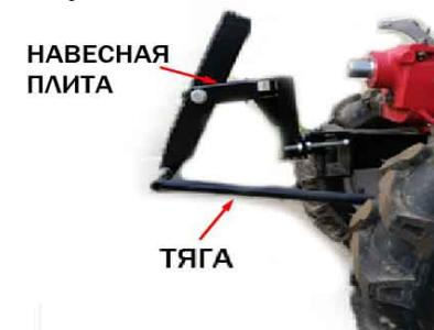
Рис. 6. Установка навесной плиты подъемного механизма.
