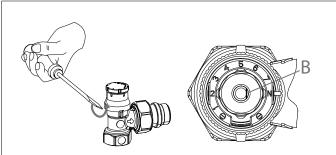
Для доступа к шкале настройки удалите красный защитный колпачок с помощью отвертки. Обозначение "N" на шкале, расположенное напротив риски "В" соответствует полному открытию клапана.
