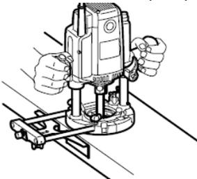
Фрезерование с параллельной направляющей.
