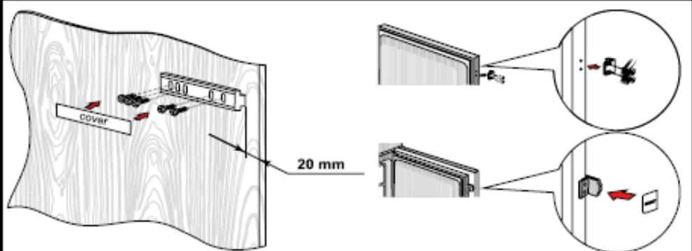
**7.** Установите крышку петли в следующем положении.
