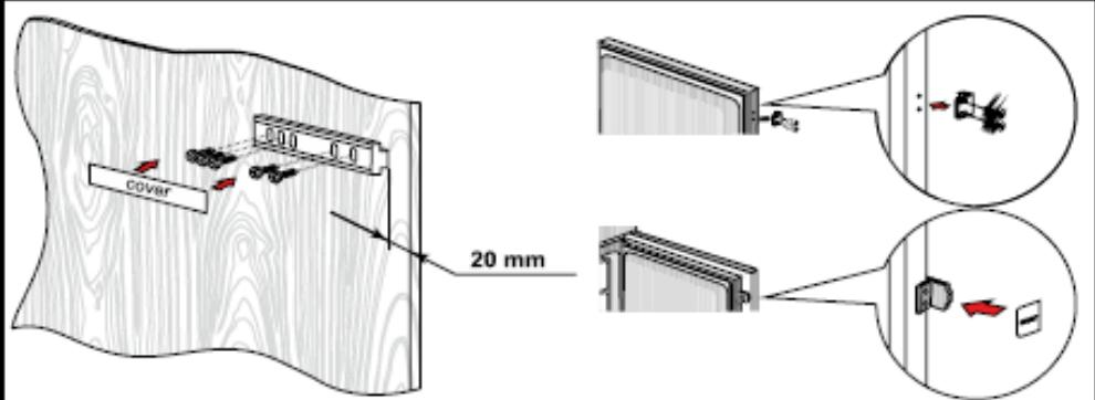
**7.** Установите крышку петли в следующем положении.
