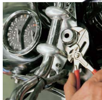
Handliches Bordwerkzeug mit vielen Anwendungsmöglichkeiten und großer Öffnungsweite von 35 mm / 1 3/8" (Modell 86 03 180).
