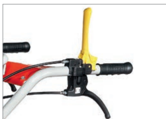
Рычаг на руле для переключения передач.
