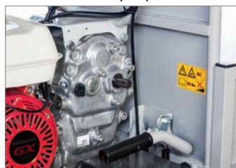
Независимый отбор мощности при 2100 об/мин.
