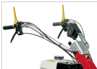
Независимые поворотные фрикционные муфты на ведущих колесах с блокировкой колес позволяют чрезвычайно легко маневрировать машиной.
