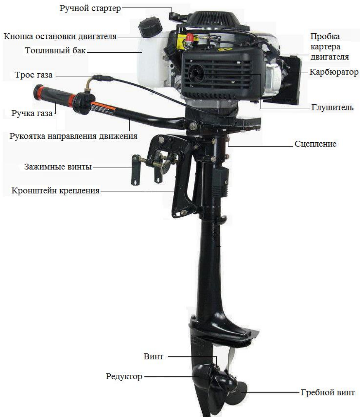
Рисунок 1 – Устройство лодочного мотора
