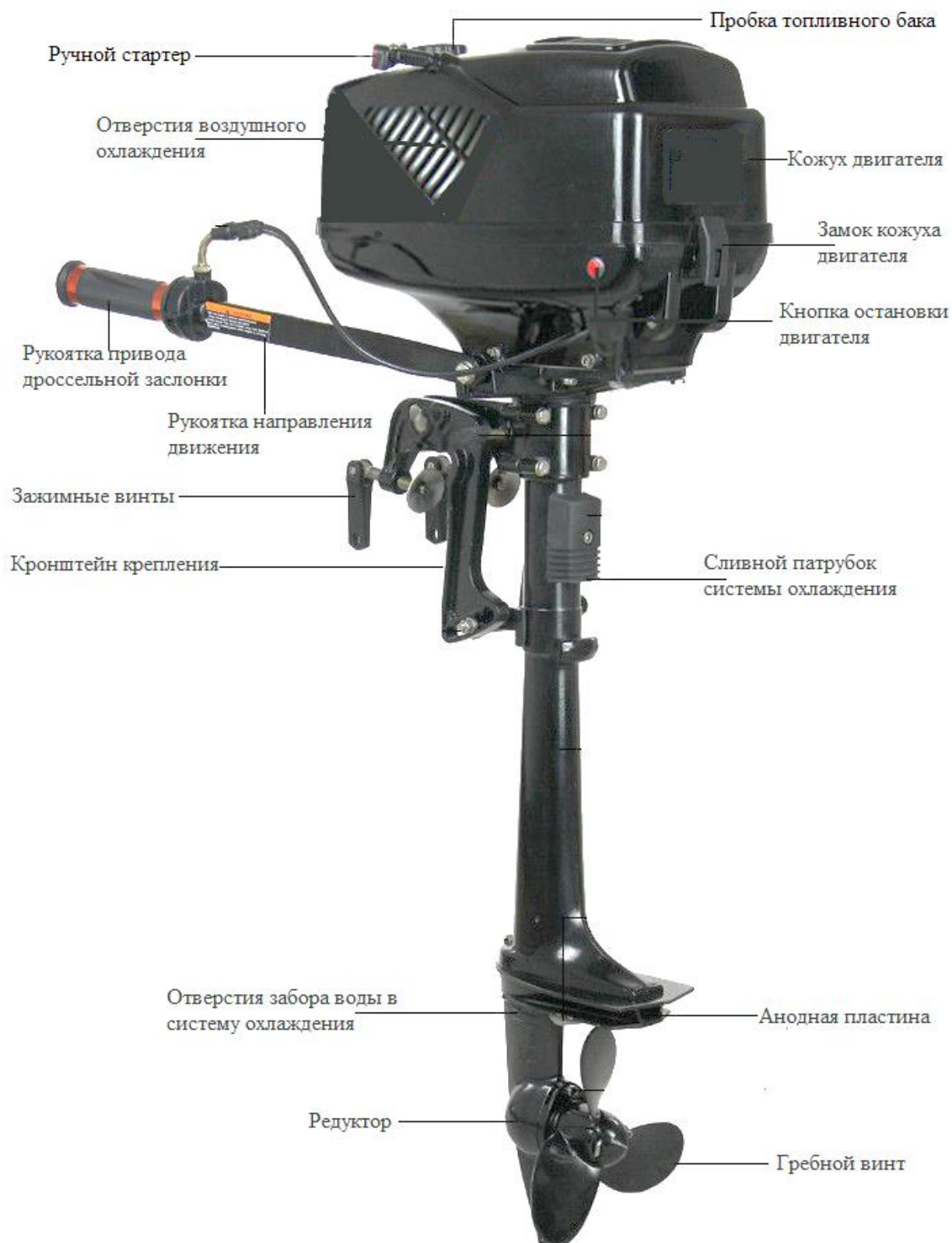
Рисунок 1 – Устройство лодочного мотора
