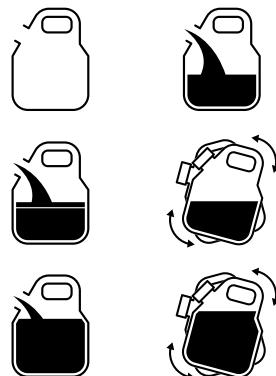
**Внимание!** Категорически запрещается смешивать бензин и масло непосредственно в топливном баке триммера.
