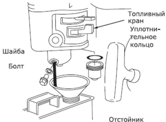
Рис. 14 – Слив топлива и очистка отстойника топливного крана
