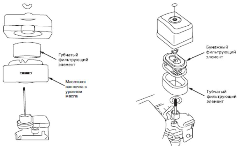
Рис.13 – Обслуживание фильтров
