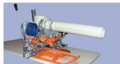
готовое сварное соединение после охлаждения
