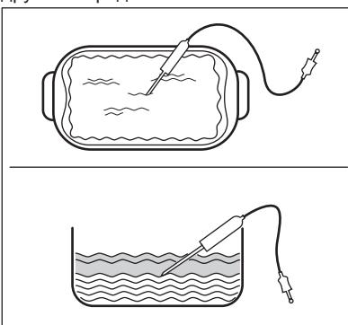
**Шаг 4** Вставьте штекер Термощуп в разъем на передней рамке духового шкафа. На дисплее будет отображаться текущая температура Термощуп.
