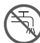
Согласно действующим предписаниям устройство запрещается подключать непосредственно к коммунальной хозяйственно-питьевой системе без системного разделителя в трубопроводе. Убедитесь, что подключение к домовой сети водопровода, к которому подсоединен моечный аппарат высокого давления, оснащено обратным клапаном в соответствии с EN 12729, тип ВА. Вода, прошедшая через системный разделитель, считается непригодной для питья.
