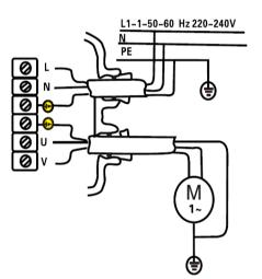
Схема подключения насосов с однофазным сечением жил, напряжением 230 В. и мощностью до 1,1 кВт.
