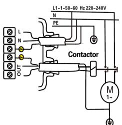
Схема подключения насосов с однофазным сечением жил, напряжением 230 В. и мощностью более 1,1 кВт., через пульт дистанционного управления.
