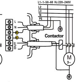
Схема подключения насосов с трехфазным сечением жил, напряжением 380 В, через пульт дистанционного управления.
